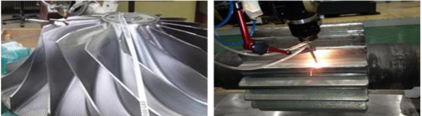
图 7：激光 3D 打印的零部件功能恢复（左）以及表面强化（右）
